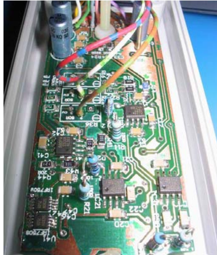
Abbildung 5: Foto der Sensorplatine. Verstärkerschaltung und Tiefpass für drei Komponenten sind auf der Platine integriert. Der Sensorchip befindet sich auf der Unterseite der Platine.
