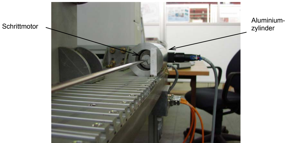
Abbildung 18: Der Schrittmotor wird von einem Aluminiummantel abgeschirmt. Dieser dämpft die Störsignale vom Motor.
