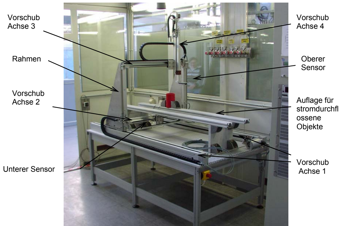
Abbildung 2: Verfahrtisch für die Magnetotomographie im IWW-3. Der Rahmen verfährt längs Achse 1. Zwei dreiachsige Magnetfeldsensoren messen das Magnetfeld des stromführenden Objektes auf der Auflage.
