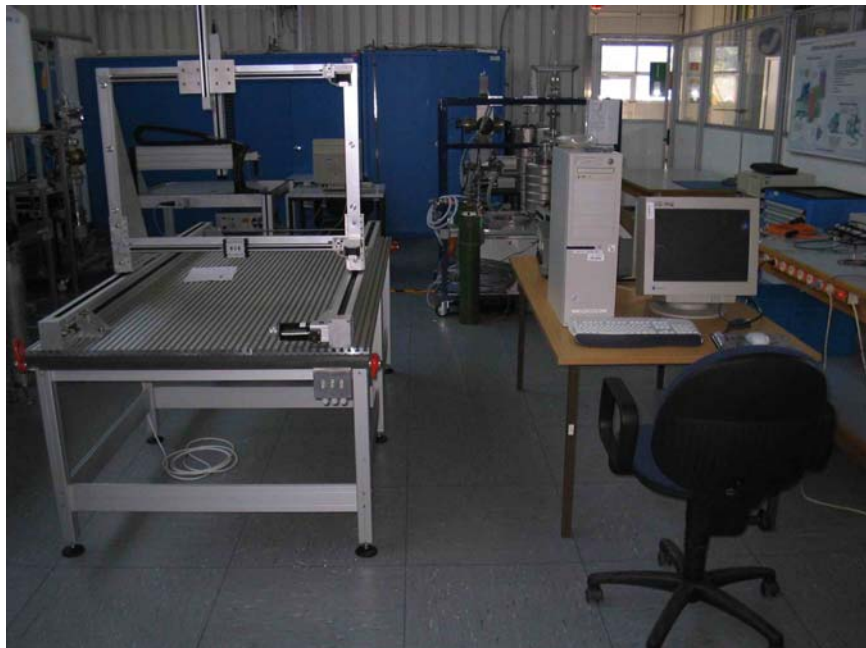
Abbildung 1: Verfahrtsch während der Aufbauphase in der ZAT. Die Sensoren werden an dem oberen und unteren Vorschub des Rahmens montiert. Der Rahmen verfährt längs des Tisches. Rechts neben dem Tisch befindet sich der Computer zur Steuerung und Datenaufnahme.
